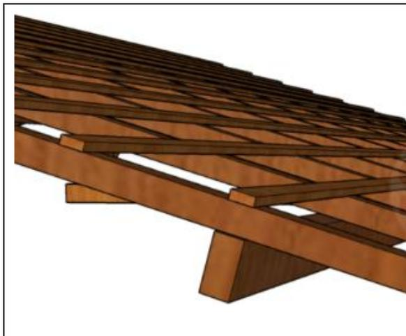
A estrutura das coberturas será em trama de madeira, composta por terças para telhados de até 2 águas para telha ondulada de fibrocimento, devendo o fornecedor apresentar o projeto de instalação antes do início dos serviços.
