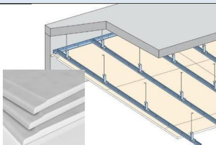
Forro de gesso acartonado com espessura 12,5 mm. Em painéis pré-fabricados e produzidos a partir da gipsita natural e cartão duplex. Fixados em perfis de chapas de aço galvanizado, espaçados a cada 60 cm, sustentados por pendurais próprios reguláveis e fixados à estrutura existente.
