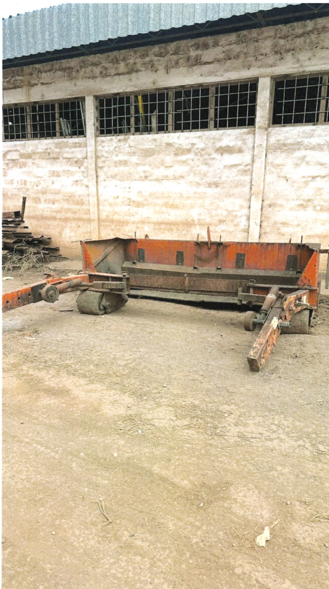
ACABADORA ASFALTO REBOCÁVEL Estado que se encontra - Pátio S.M.O. ①
