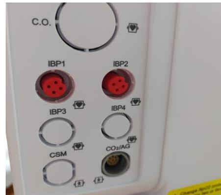
Em simples análise do monitor apresentado nota-se a apresentação de parâmetros básicos pré-configurados sendo eles: ECG, RESP, NBP SPO2, TEMP, IBP1 e IBP2 (PNI). Visualmente é possível notar logo abaixo do IBP 1 e 2 duas caixas fechadas com a descrição acima nominadas IBP 3 e IPB 4, o que conforme manual apresentado demonstram se tratar de pontos opcionais para capacidade de implementação de expansão modular.
